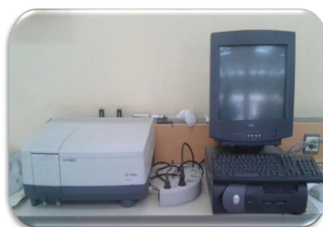
Figure 3.5 : Schéma de principe d'un spectrophotomètre à double faisceaux de marque SHIMADZU (UV 1650 PC).
