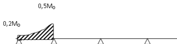
Figure III.08: valeurs admissibles (travée de rive).
