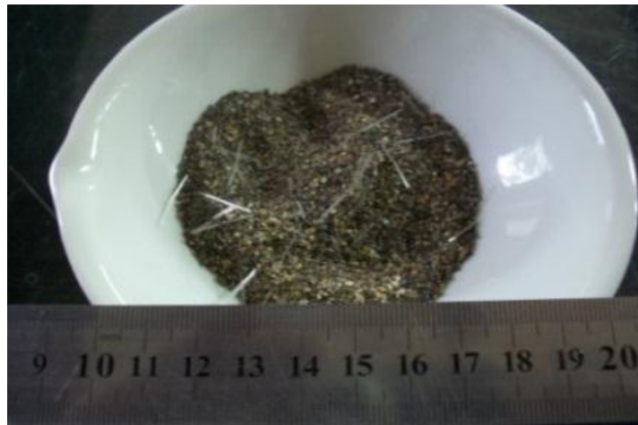
Figure 4.3: Préparation des échantillons secs (sable + fibres de verre)
