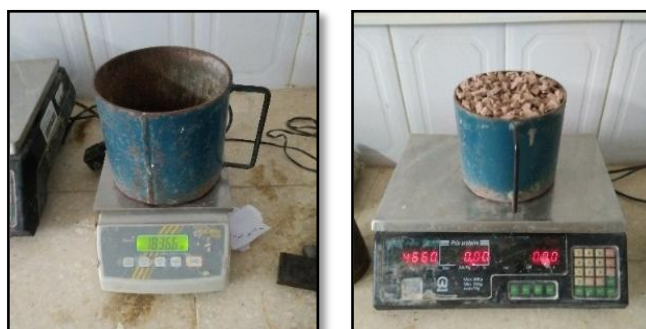
Figure VI.13: Détermination des masses volumiques
