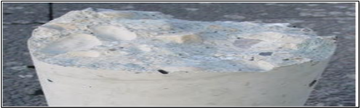
Figure II.15: Mode de rupture en traction directe d'une éprouvette dont les granulats sont principalement déchaussés [12]
