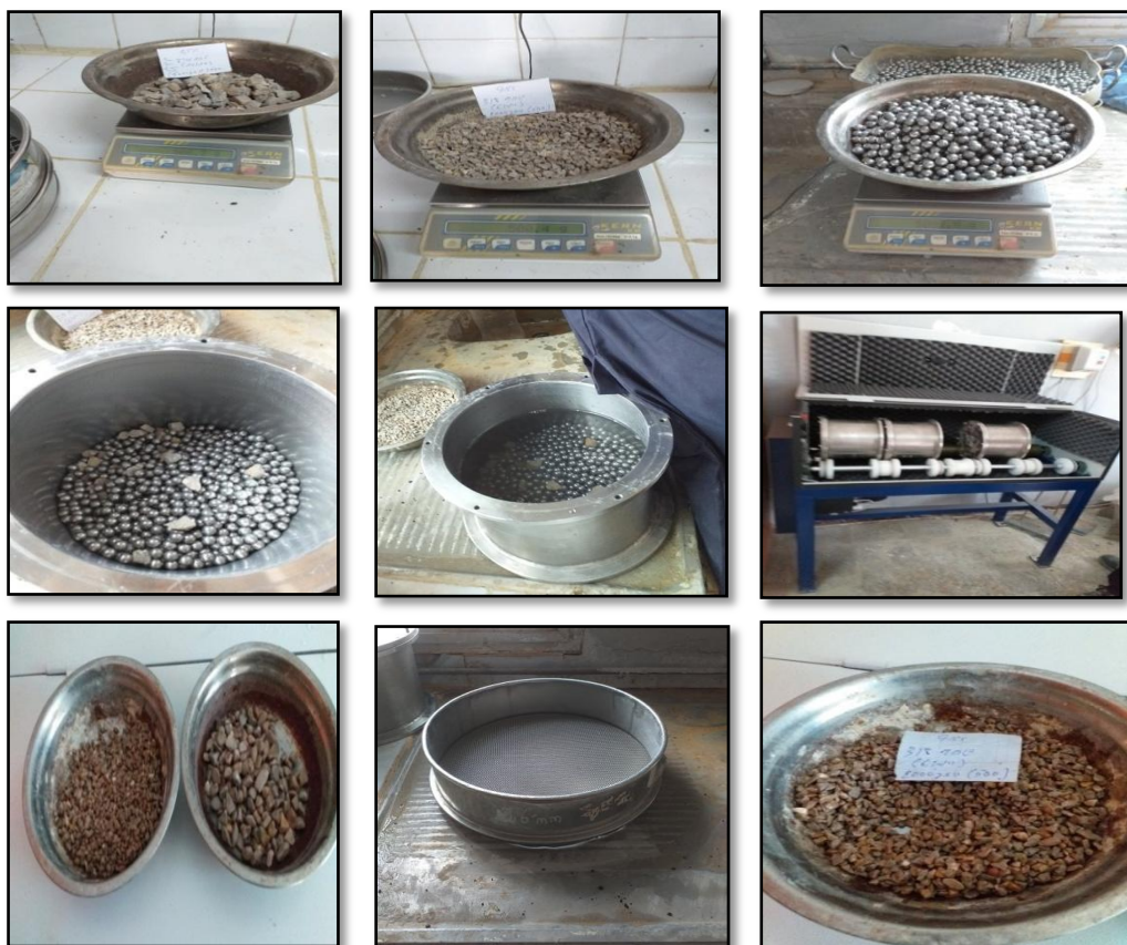
Figure VI.25 : Procédure de l'essai Micro-Deval
