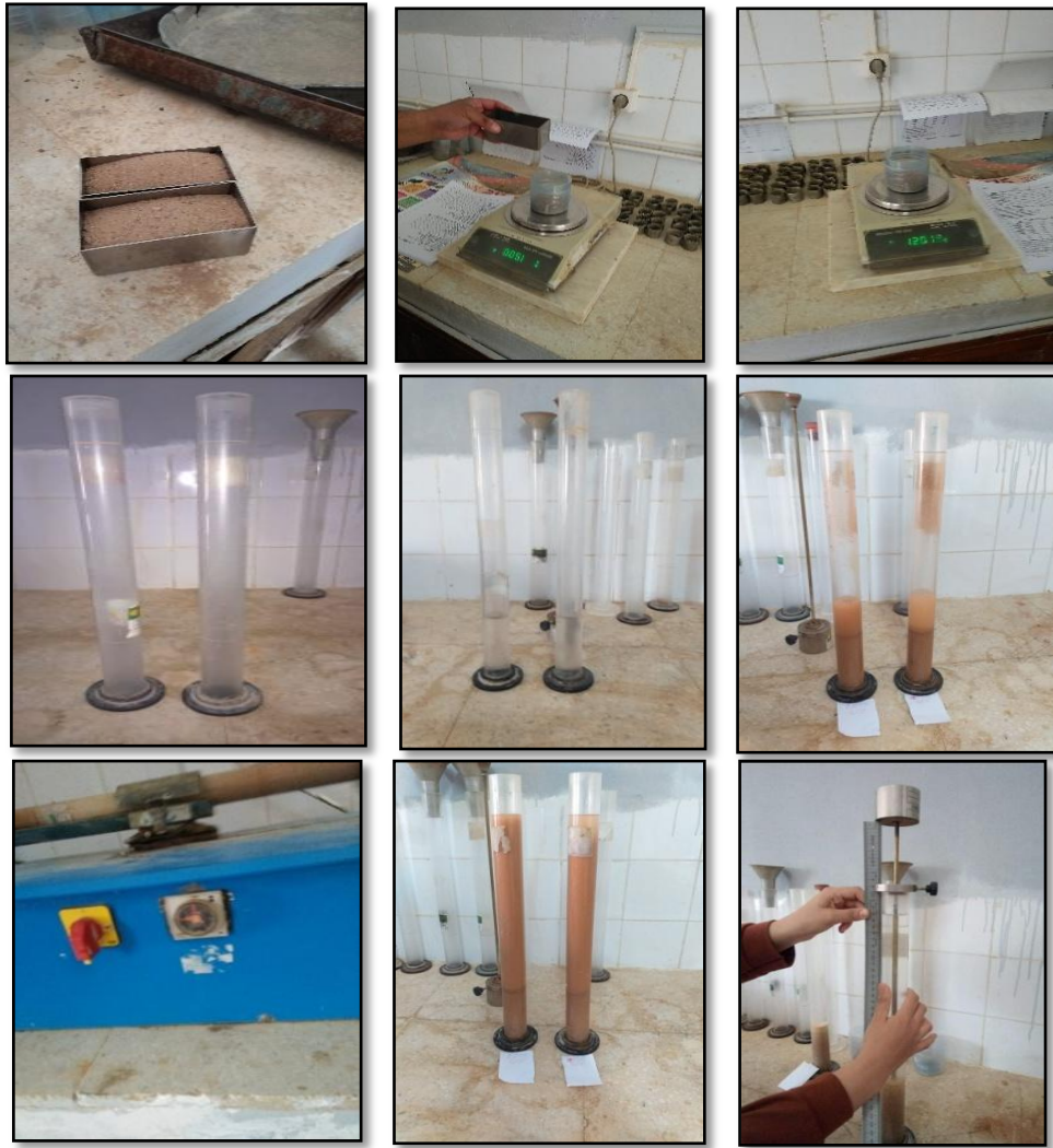
Figure VI.5 : Procédure de l'essai d'équivalent de sable
