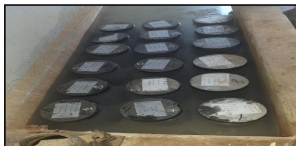
Figure VI.35: Conservation des éprouvettes dans l'eau
