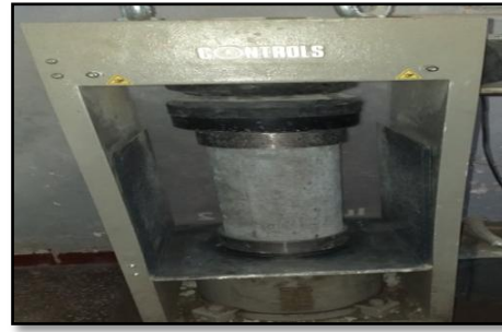
Figure VI.37: Chargement des éprouvettes cylindriques pour essai de compression
