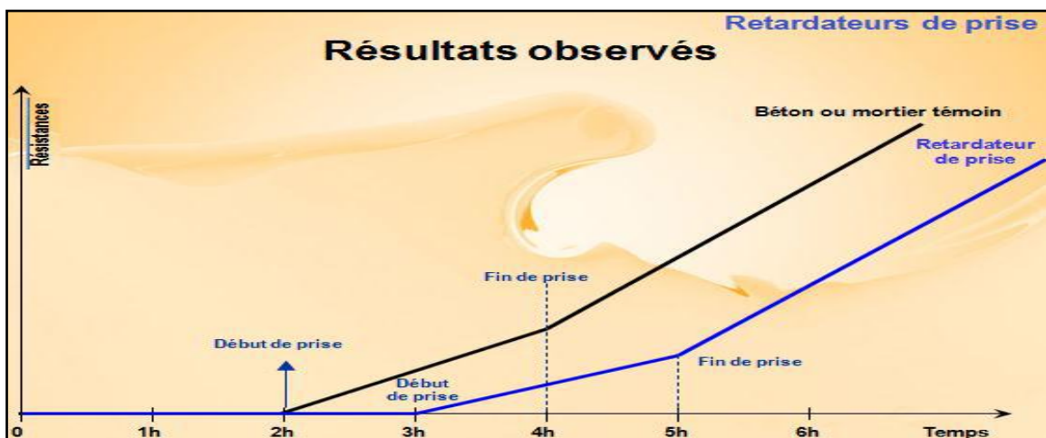
Figure III.11 : Schéma de l'influence comparée d'un mortier ou béton avec et sans retardateur sur l'évolution des résistances [22]
