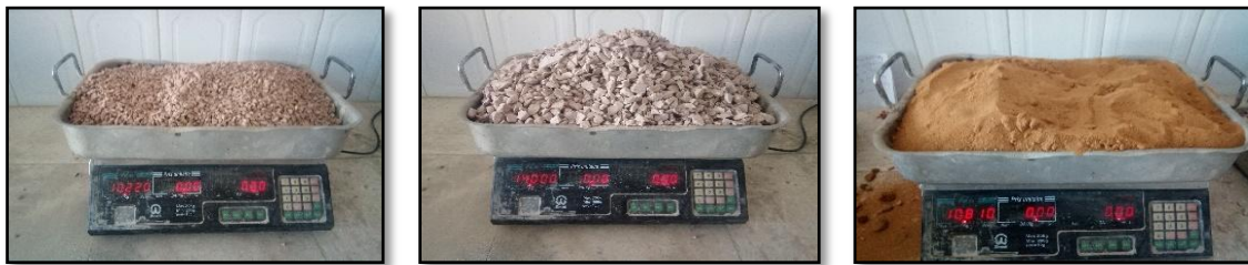
Figure VI.27: Préparation des ingrédients secs pour la confection des mélanges de béton (BO, BA) (Annexe IV)
