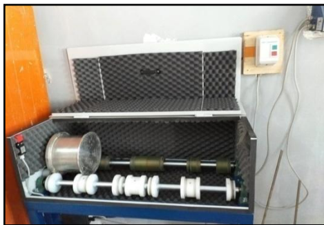
Figure VI.23 : Machine de l'essai Micro-Deval
