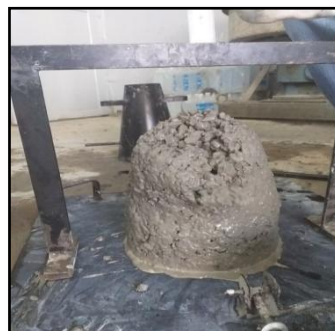
Figure VI.29 : Essai de l'affaissement (Annexe IV)
