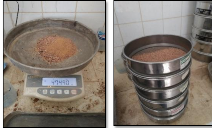
Figure VI.11: Essai d'analyse granulométrique
