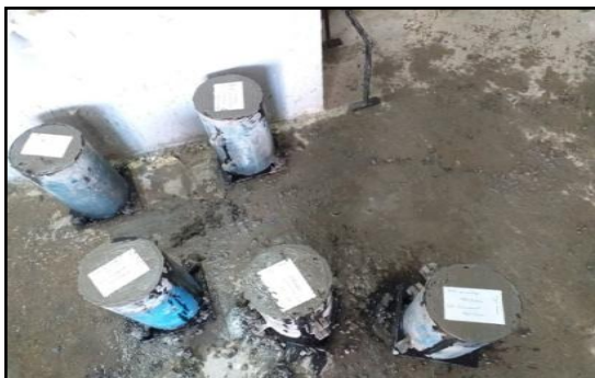
Figure VI.33 : Eprouvettes avant démoulage
