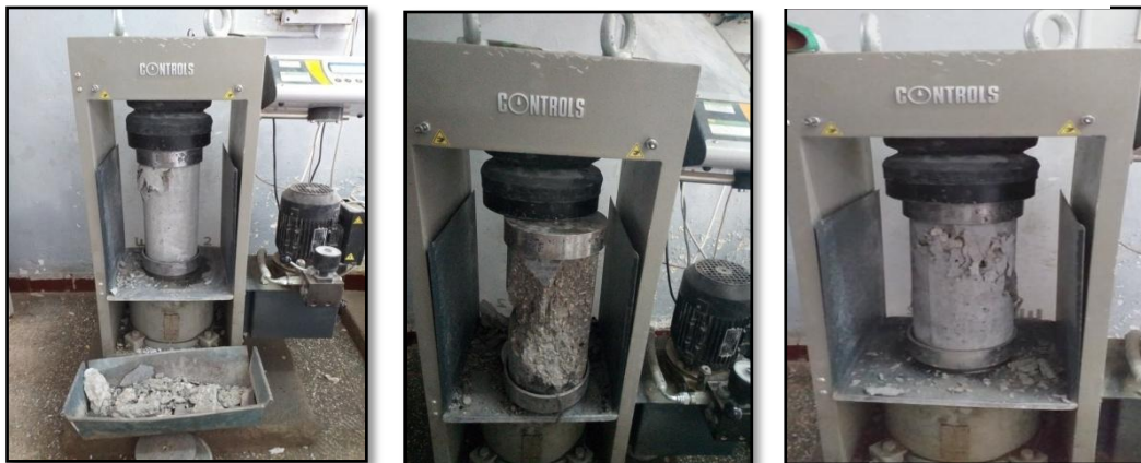
Figure VI.38 : Eprouvettes après écrasement
