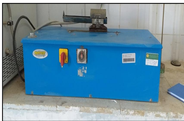
Figure VI.3 : Machine d'agitation électrique
