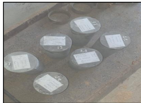
Figure VI.34: Eprouvette après démoulage
