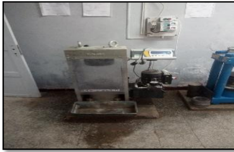
Figure VI.36 : Machine d'essai d'écrasement
