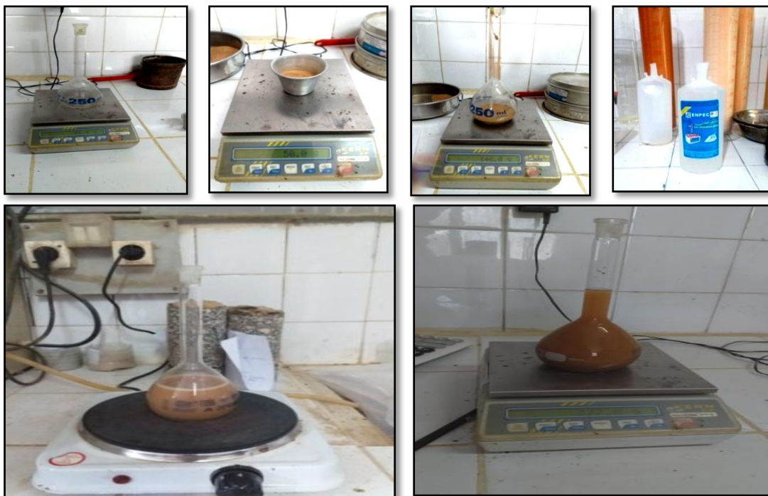
Figure VI.14 : Détermination des masses volumiques absolues
