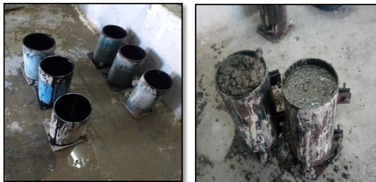
Figure VI.32: Remplissage des moules (16x32) cm
