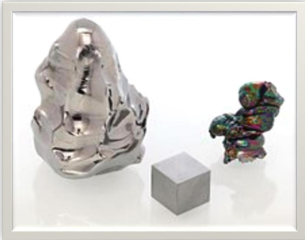
**Figure 5 :** Hafnium, soudé par faisceau d'électrons (à droite). [18].
