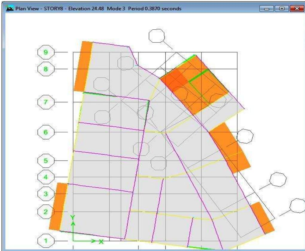
Figure IV.7 : Mode 3 rotation suivant z-z
