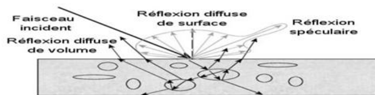
FIGURE 2-2: Description schématique de la propagation d'un rayon incident [22].
