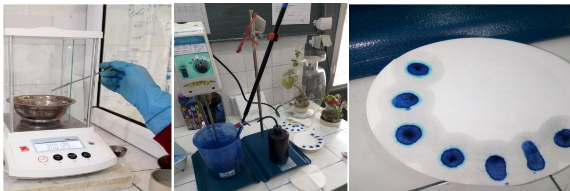
Figure IV.2 : Les étapes de l'essai de bleu de méthylène
