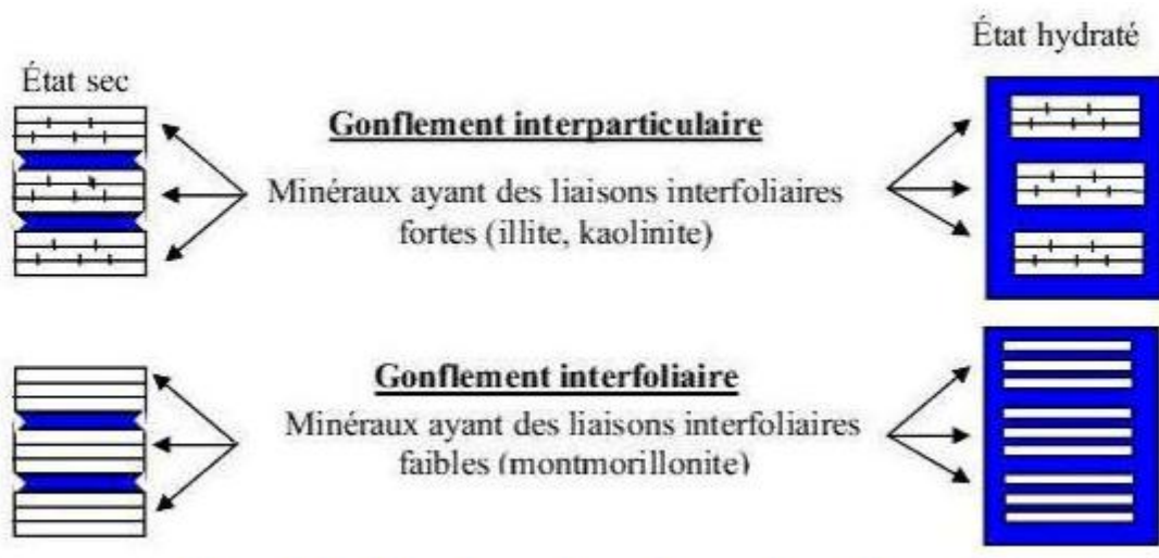
Figure III-8: Mécanismes de gonflement des argiles par hydratation.
