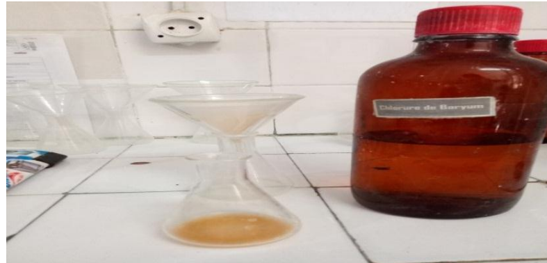
Figure VI.3 Dispositif d'essai de la teneur en sulfates
