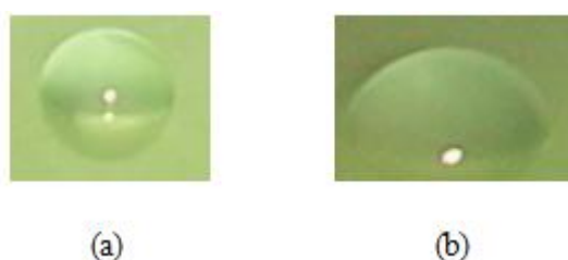
Figure IV.4-2: Allure d'une goutte d'eau sur un film de PEBD (a : hydrophobe) non traité, (b : hydrophile) traité par décharge couronne.
