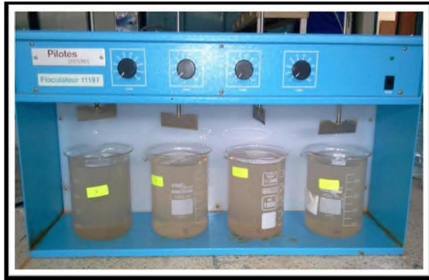
**Figure I.1 : Jar Test**
