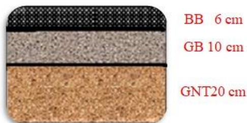
Figure (II.1) Schéma corps de chaussée
