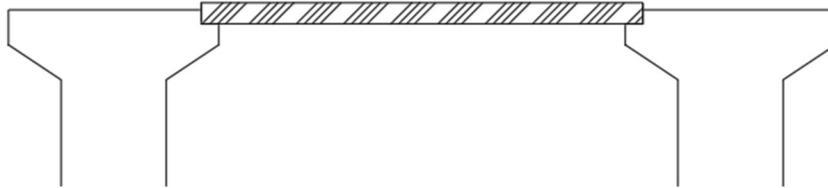
Figure 3.8: : Schéma de la pré dalle
