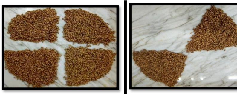
Photo N°02 : Echantillon séparé en quatre et deux parties égales par la méthode de cône .
