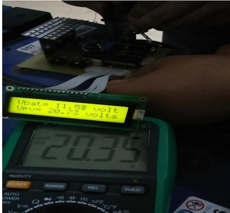
**Figure III- 10 :** Premier essai de calibration des mesures de tensions
