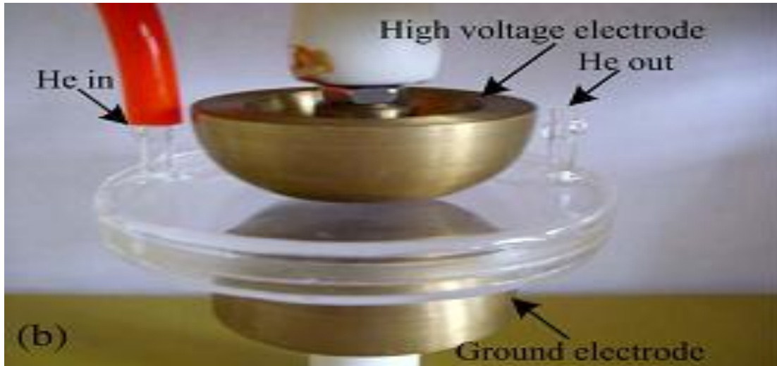
Figure II-1. Réacteur DBD pour la configuration plane –parallèles [34]
