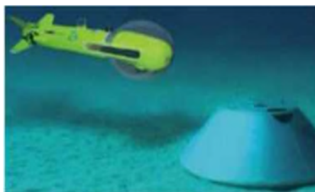
Figure 1.2 : Le K-Ster (France) à l'approche d'une mine de fond
