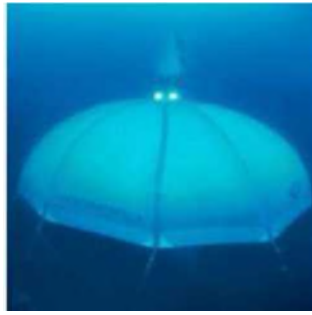
Figure 1.4 : Un système de captage d'eau douce © Nymphéa Water
