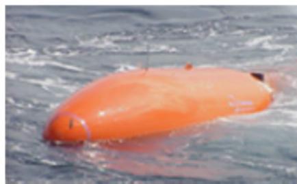
Figure1.18 AUV forme ellipsoïdale.
