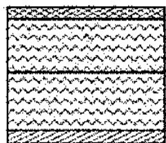
Figure VIII.6. Structure type d'une Chaussée Semi-Rigide (LCPC, 1994)
