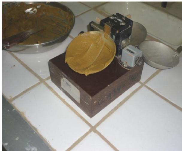
**Figure 3.9:** Fermeture de la rainure
