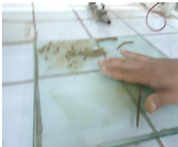
**Figure 3.11:** Confection du rouleau pour la détermination de la limite de plasticité
