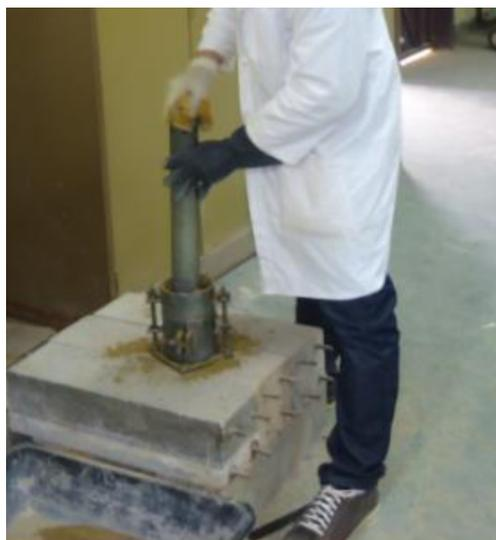
**Figure 3.14:** Compactage des éprouvettes
