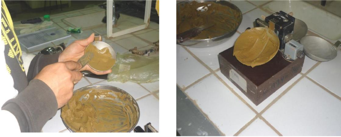
**Figure 3.8:** Remplissage de la coupelle et réalisation de la rainure
