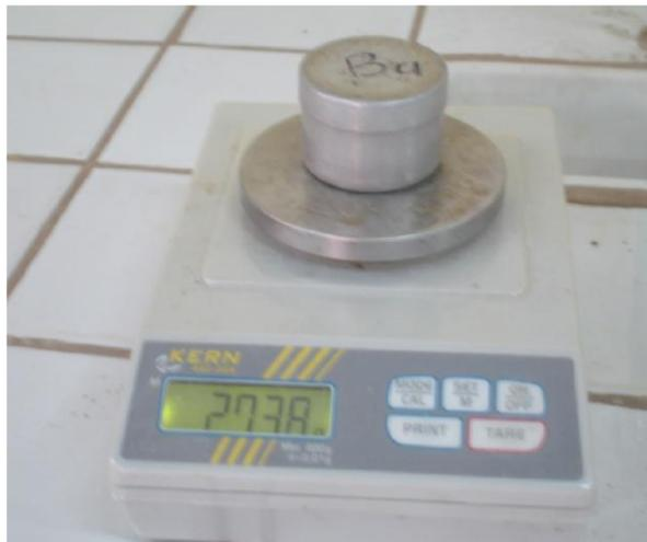
**Figure 3.10:** Prélèvement pour la mesure de la teneur en eau
