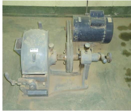
(b) Broyeur à disque
