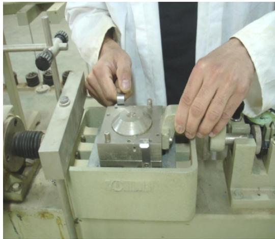
**Figure 3.19:** Mise en place de l'éprouvette
