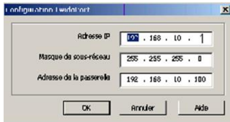
Figure 3.4: configuration de l'adresse IP d'automate
