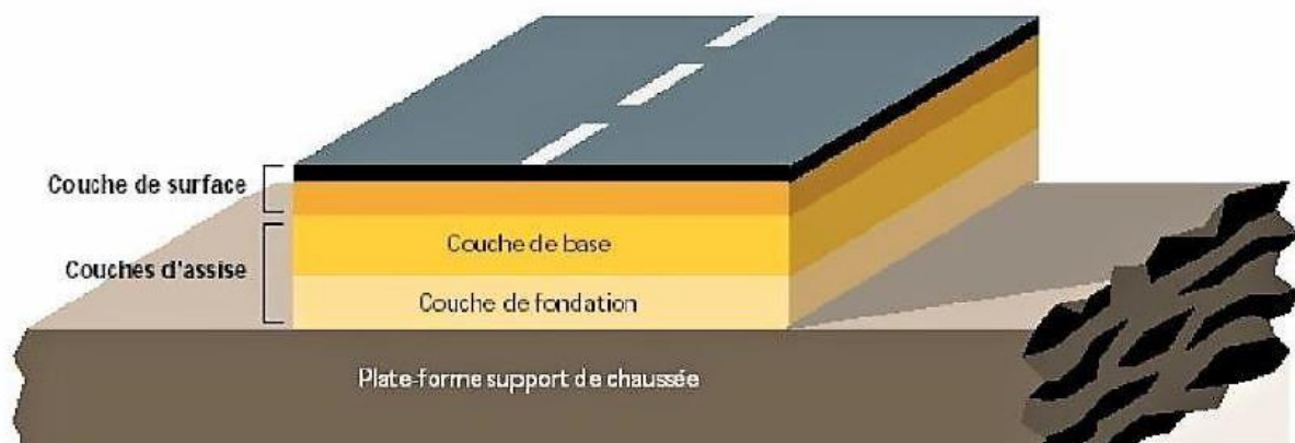
Figure 4.2 : Structure de chaussée souple
