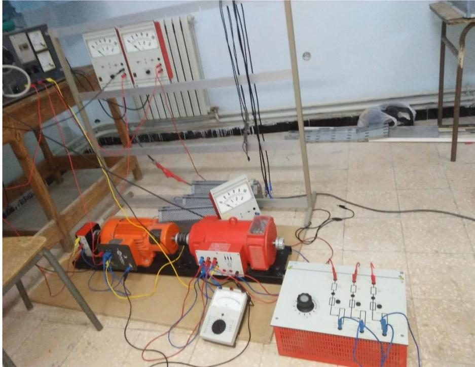
**Figure V. 8** Application du couple résistant avec génératrice
