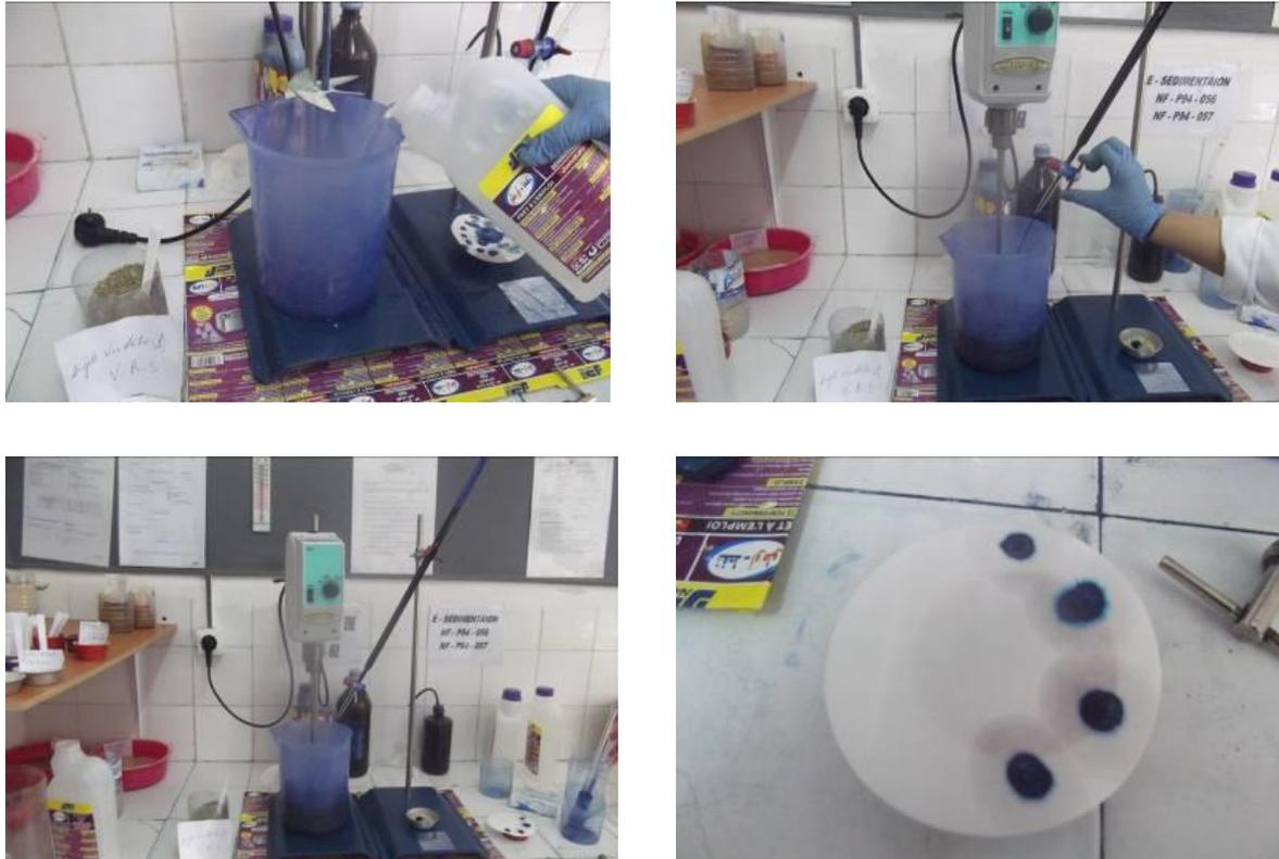
*Fig. (III.12): Mode opératoire d'essai de bleu méthylène*
