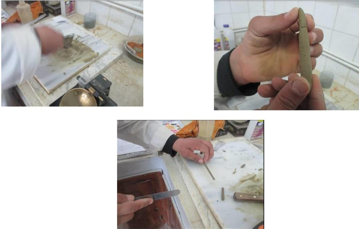
*Fig. (III.11): Mode opératoire pour détermination de la limite de plasticité*
