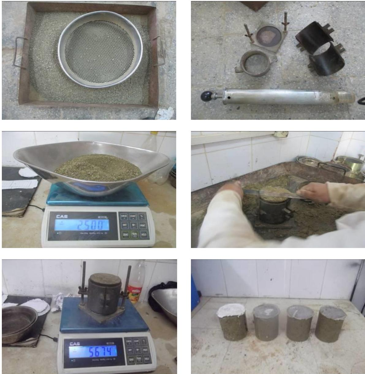
*Fig. (III.15): Mode opératoire de l'essai Proctor*
