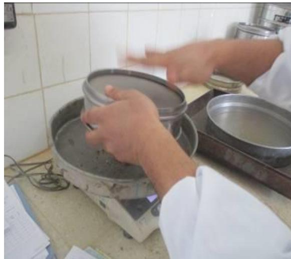
*Fig. (III.8) : Mode opératoire l'essai analyse granulométrique par tamisage*
