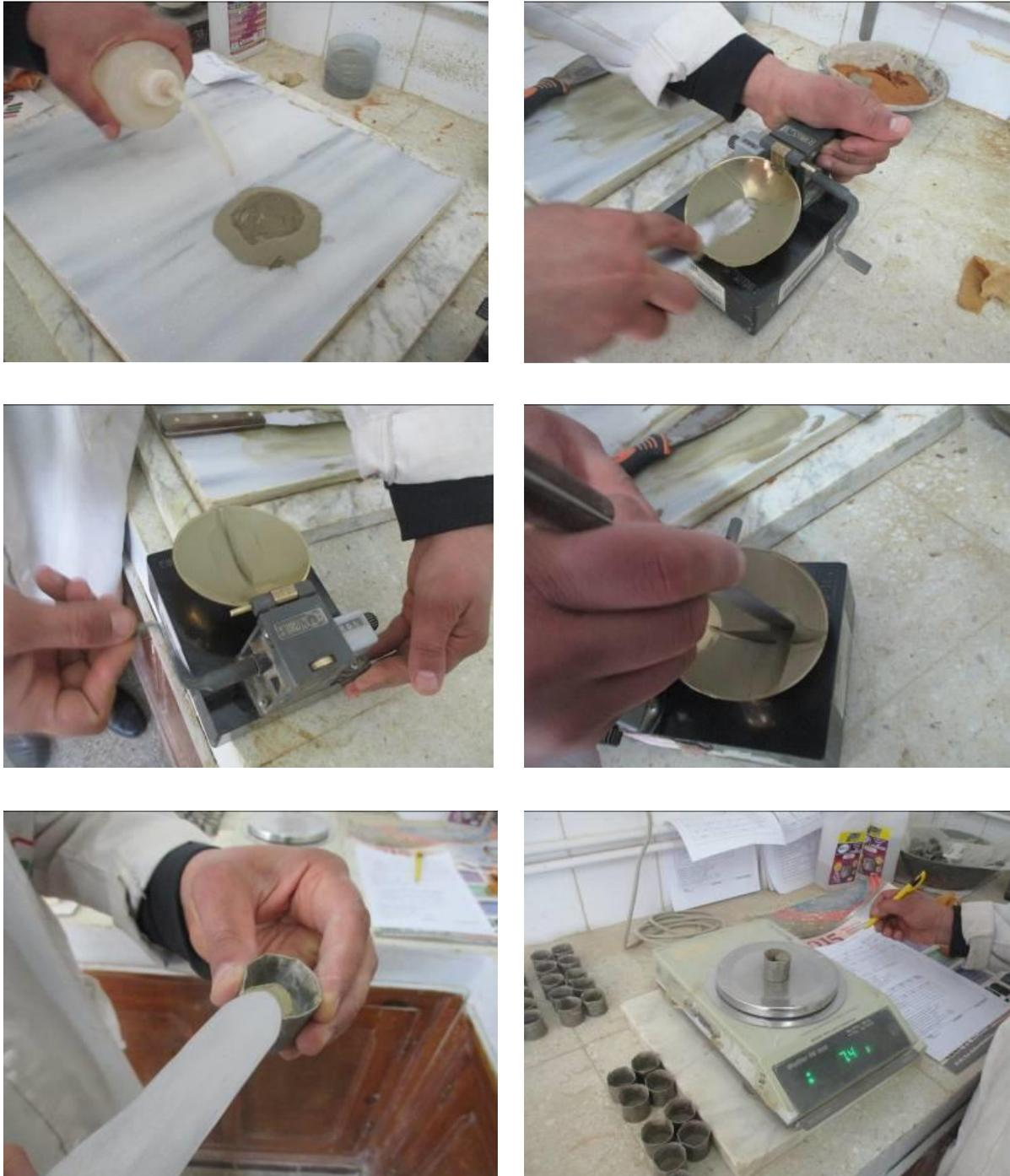
*Fig. (III.10): Mode opératoire pour détermination de la limite de liquidité*
