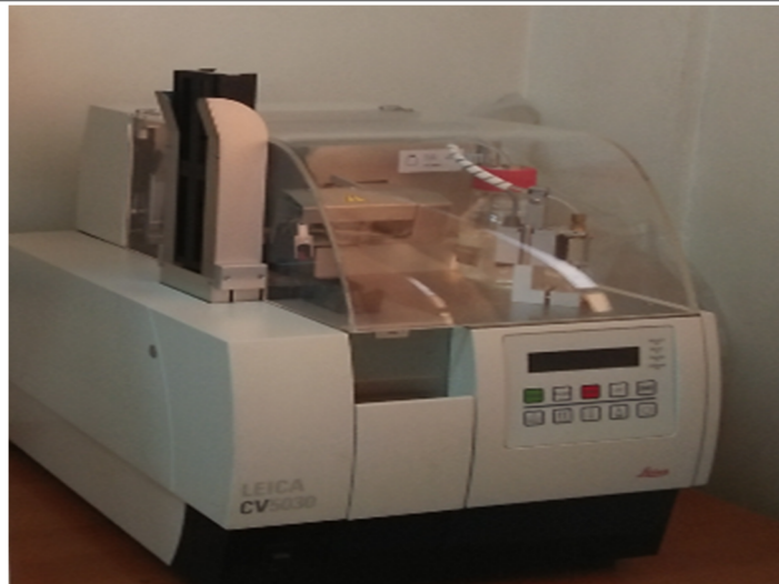
Figure 3. Automate de montage (Leica CV 5030).
