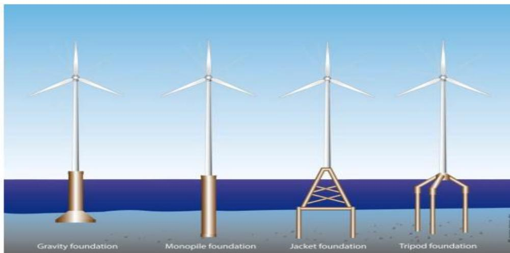
Figure I.18 : Fondation par caisson, à mono pilot, jacket et à trépied des éoliennes offshore [20].
