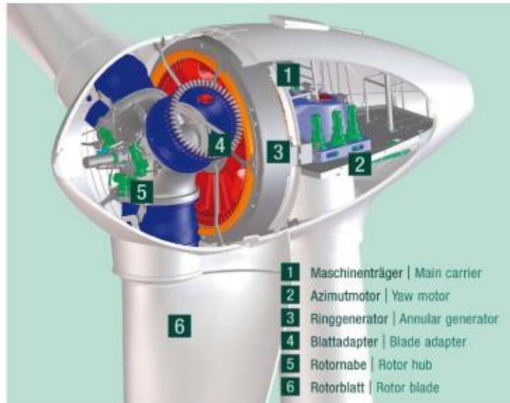
Figure I.15 : Éolienne sans multiplicateur [16].
