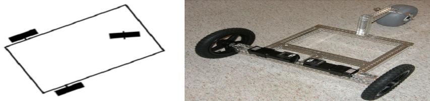
**Figure I.4** : Robot de type tricycle
