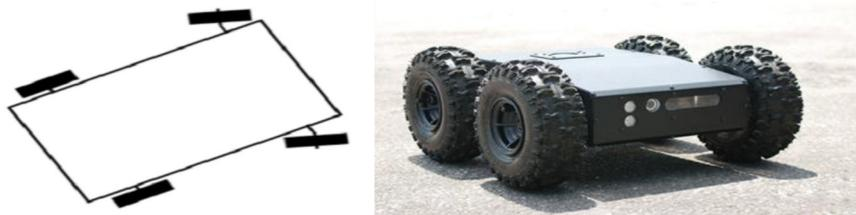
*Figure I.5 : Robot de type voiture*
