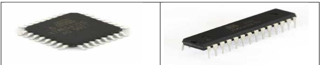
*Figure III.5: Microcontrôleur ATmega328*
