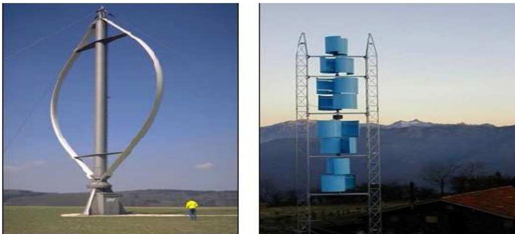
Figure I.4 :Eoliennes à axe vertical : rotor de Darrieus (gauche) et rotor de Savonius (droite)
