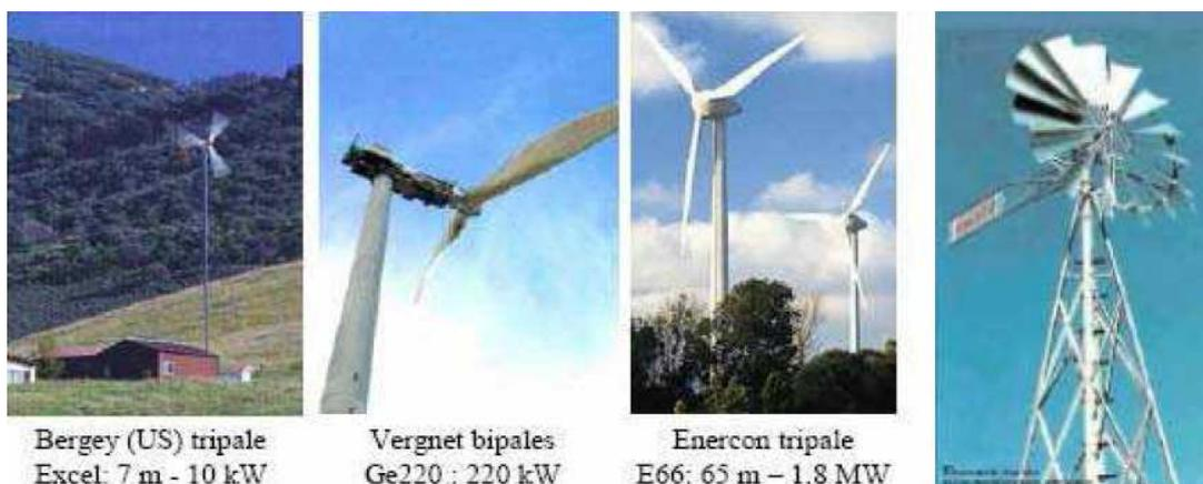
Figure I. 5 : Éolienne à axe horizontale.
