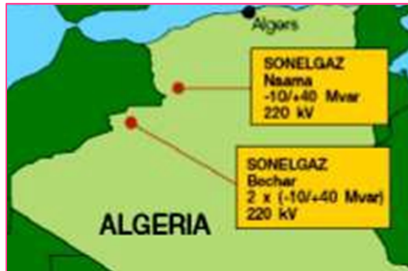
Figure II.5. Un dispositif SVC à la sous station de Naama et deux à Béchar.
