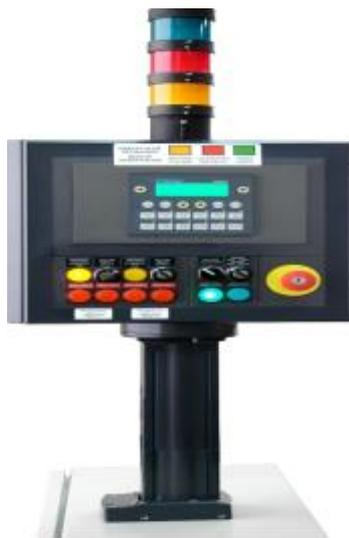
**Figure 2.19 : Implantation de l'interface homme-machine sur un pupitre déporté**
