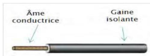
Figure 2.5 : Conducteur électrique isolé
