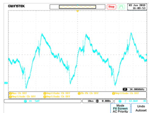
FIGURE 4.17 – résultat expérimental du courant en boucle fermé tension mode DCM.
