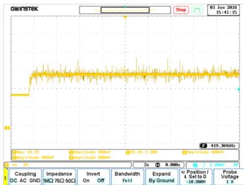
FIGURE 4.13 – résultat expérimental de tension en boucle fermée tension mode CCM.
