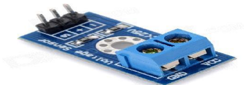
Figure IV. 7 : Capteur de tension pour Arduino.
