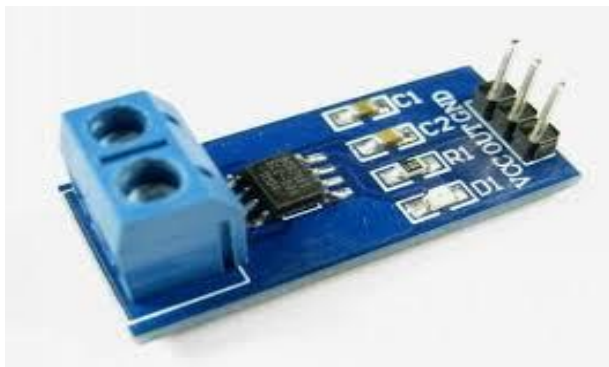
Figure IV. 6 : Capteur de courant ACS712.
