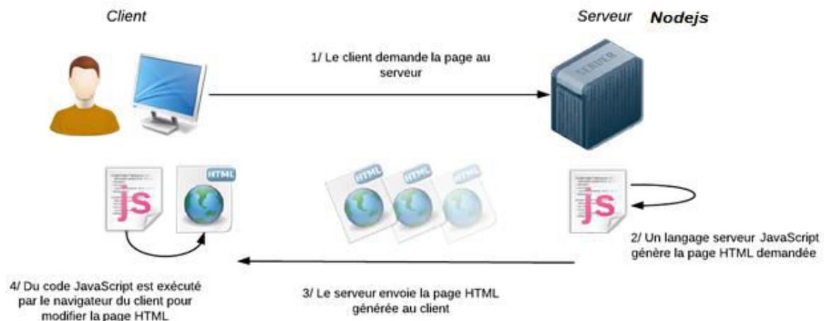
Figure 06 : Communication entre le serveur de Pcdduino et le client
