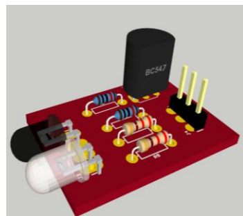
Figure. V.19 Carte n°2 réalisée sous EAGLE en visualisation 3D
