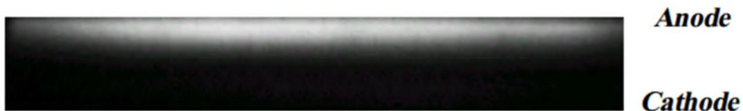
**Figure I.7 :** Photographie d'une décharge de Townsend dans l'azote [15]
