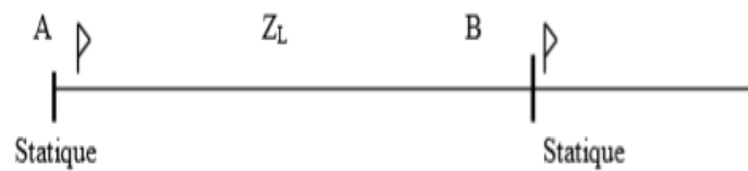
Fig IV.13. Les zones de réglage de protection statique
