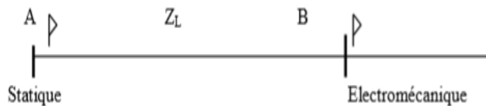
Fig IV.14. Les zones de réglage de protection statique/electromécanique
