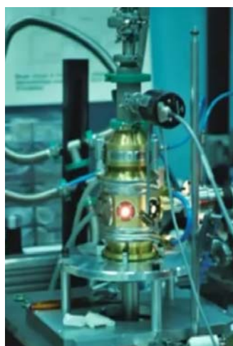
Figure I-20 Schéma de l'appareillage d'ablation laser.
