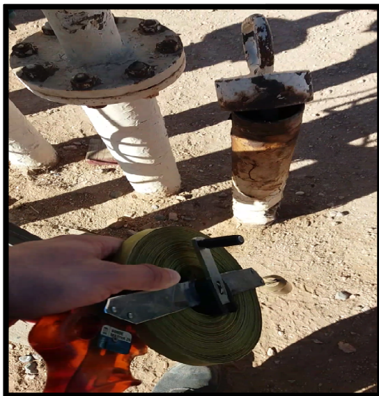
FigureIII-1 a) Prise de jaugeage manuel
