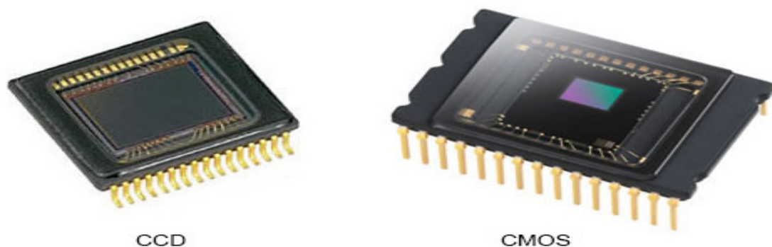
Figure II.7: capteur CCD et capteur CMOS
