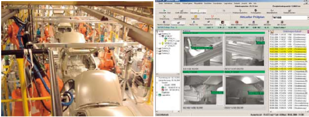
Figure I.2. Interface utilisateur 4 photos de caméra : ligne complète de scellage, robot guidé par caméra
