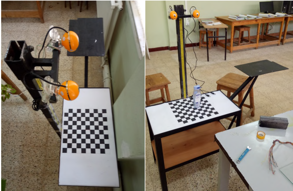
Figure III.3 :la table de calibration de deux caméras de la stéréovision.
