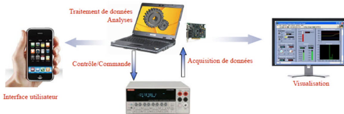
Fig. (I.2): Acquisition et traitement de données par Labview .
