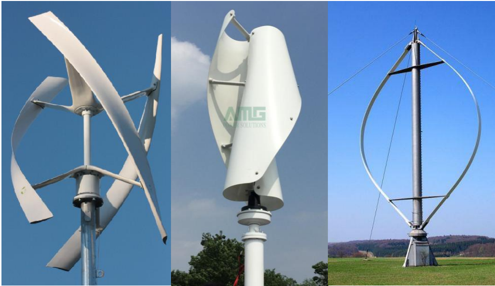
Fig.I.6 : Eolienne à axe vertical
