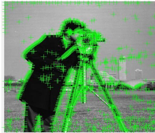
**Figure 2. 7:** Image cameraman.tif soumise au détecteur de points clés SIFT
