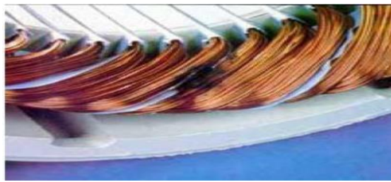
Fig.I.10: Défaut de court-circuit entre phases. [5]
