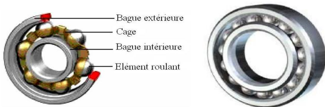
Fig. II.01 : Différentes composantes d'un roulement. [18]
