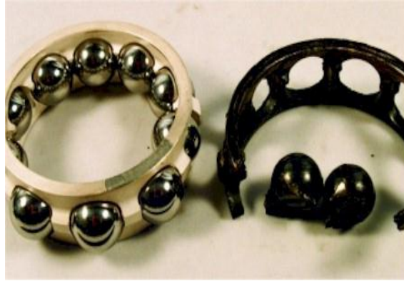
Fig. II.07 : Détérioration des cages. [21]
