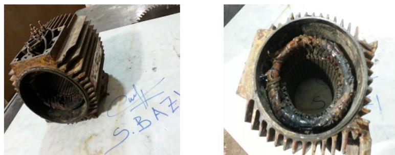
Fig. I.09: Stator d'un moteur asynchrone complètement grillé. [5]
