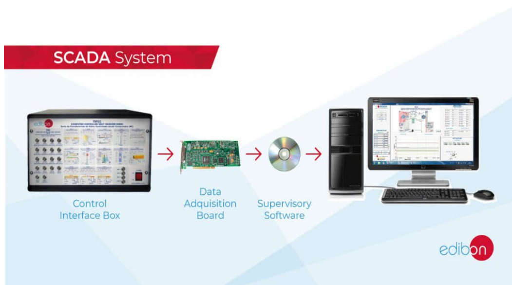
Figure I. 4 différentes parties du système SCADA
