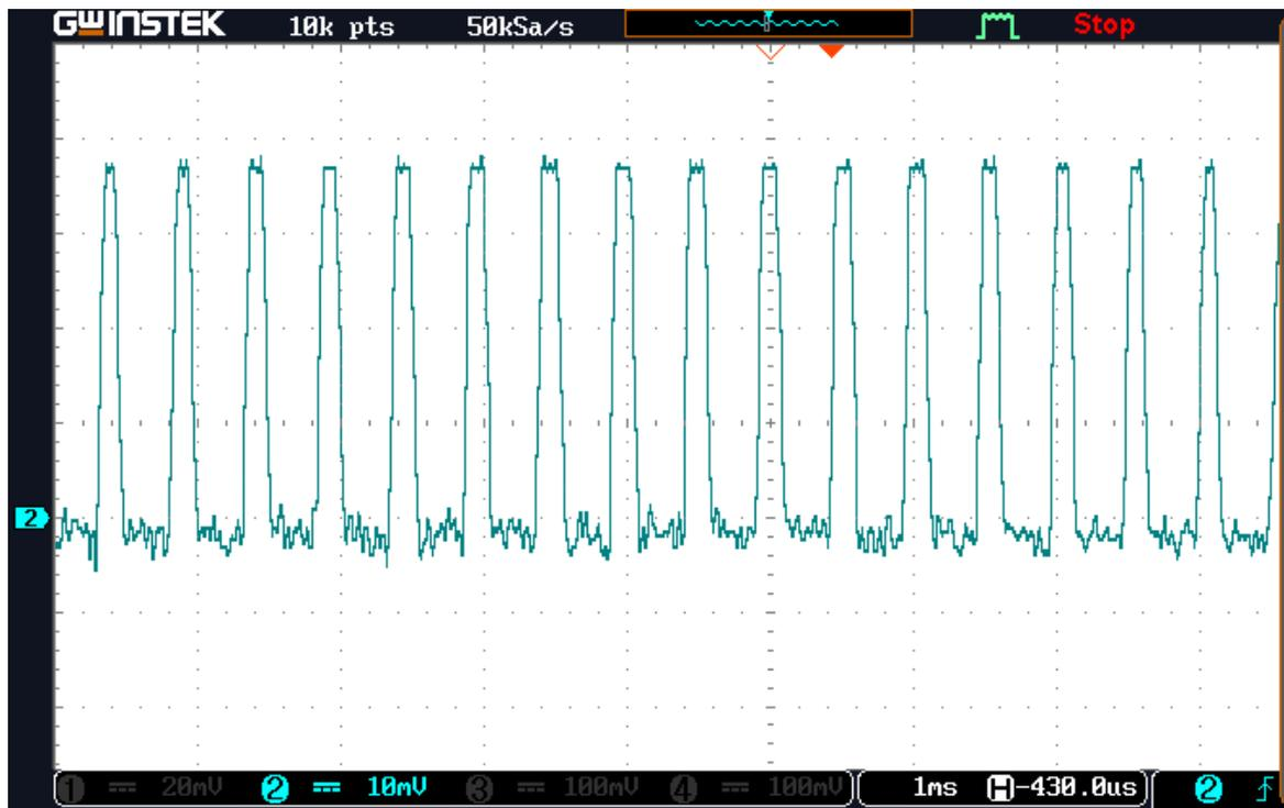
FIGURE 4.18 – Résultat expérimental du courant de la bobine pour une référence de 5V (Buck)
