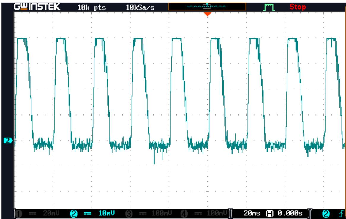
FIGURE 4.16 – Résultat expérimental du courant de la bobine pour une référence de 10V (Buck)
