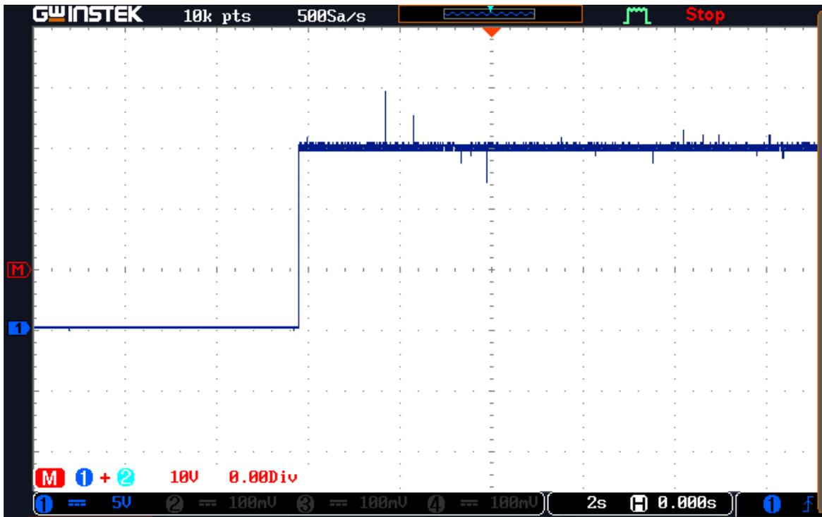
FIGURE 4.9 – Résultat expérimental de la tension de sortie pour une référence de 15V (Boost)
