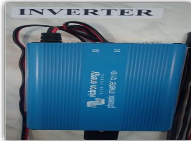
Figure.3.6 : Onduleur Phoenix 12v 180 VA.
