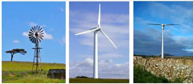
Figure I. 6 Éolienne à axe horizontal
