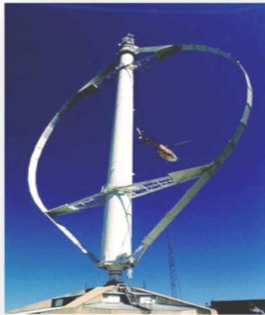
Figure I. 8 Eolienne de Darrieus
