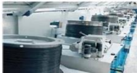
Figure 1. 16 Chaîne de tréfilage de câbles
