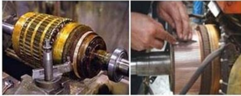
Figure 1. 3 Composition de l'induit
