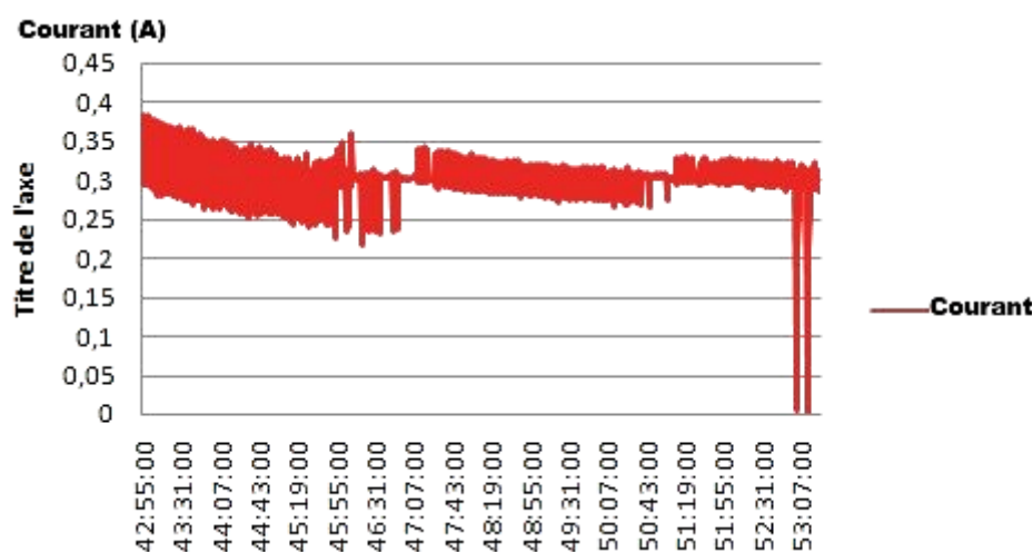
Figure III- 19 : Le courant pendant un cycle de charge
