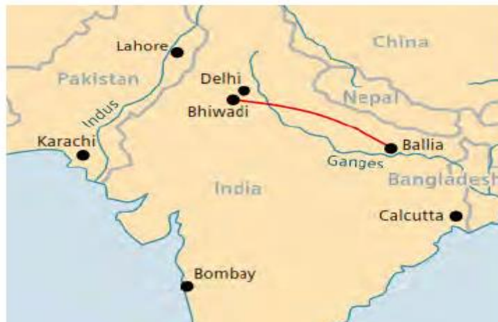
Fig.II-2 : Liaison HVDC en Inde entre les stations de conversion de « Ballia » et de « Bhiwadi » d'une longueur de 800 km
