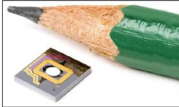
Fig.I.6 : Visualisation de l'échelle d'un MEMS [21].
