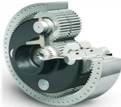
Fig. II-19 : Exemple mécanique du multiplicateur.
